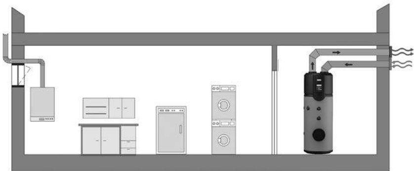
Abb. 9.8.4 - Warmwasser-Wärmepumpe mit Zu- und Ab- Luftkanal Nutzung der Aussenluft als Energieträger
